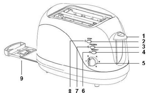
1. Dźwignienka opuszczania pieczywa włączająca toster
